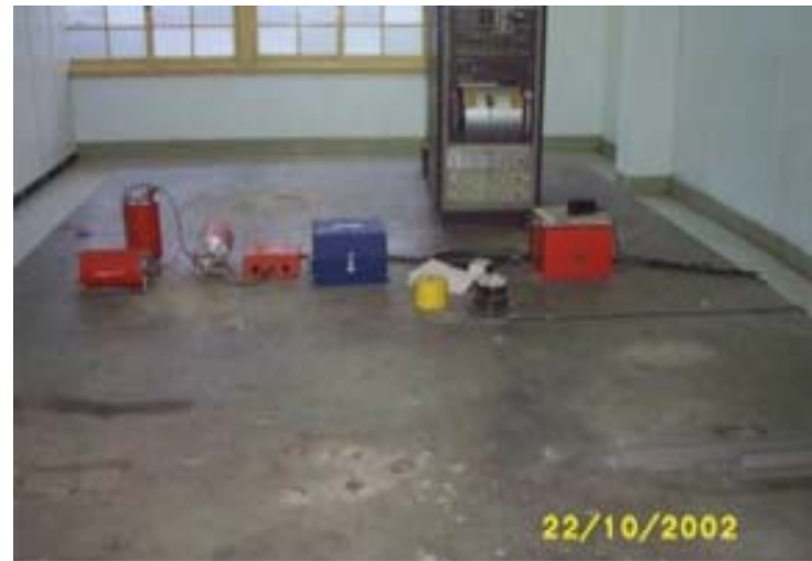
強震儀位置於阿里山氣象站室內，氣象站是日據時代所構築之木造2層樓房，儀器是設置在長×寬×高(3.64×5.45×1.8m)的混凝土基台上。
