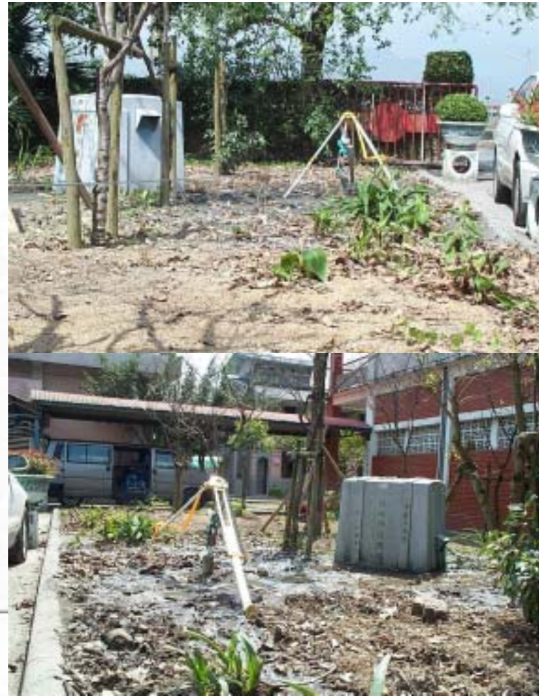
本測站位於育才國小內側門北側相距10公尺之花圃內,測站北側約六公尺為一二樓RC結構教室,如示意圖所示,裝設地點並非為擋土結構,亦不與鄰近結構物相連.
