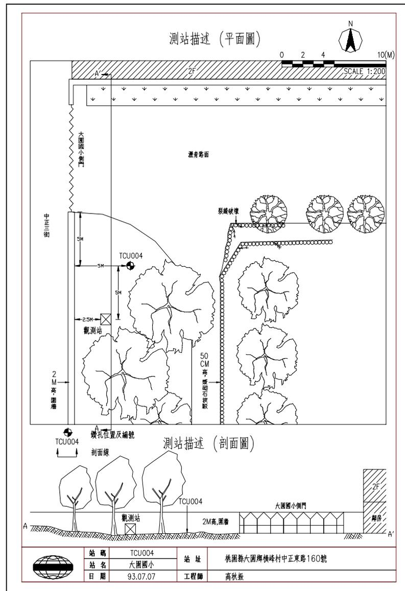
1. 本測站位於學校西北角側門圍牆旁之樹叢內，地勢為向南緩升，測站東側隔約3m道路外有約0.5m高漿砌石坡駁，角隅有裂縫破壞。
