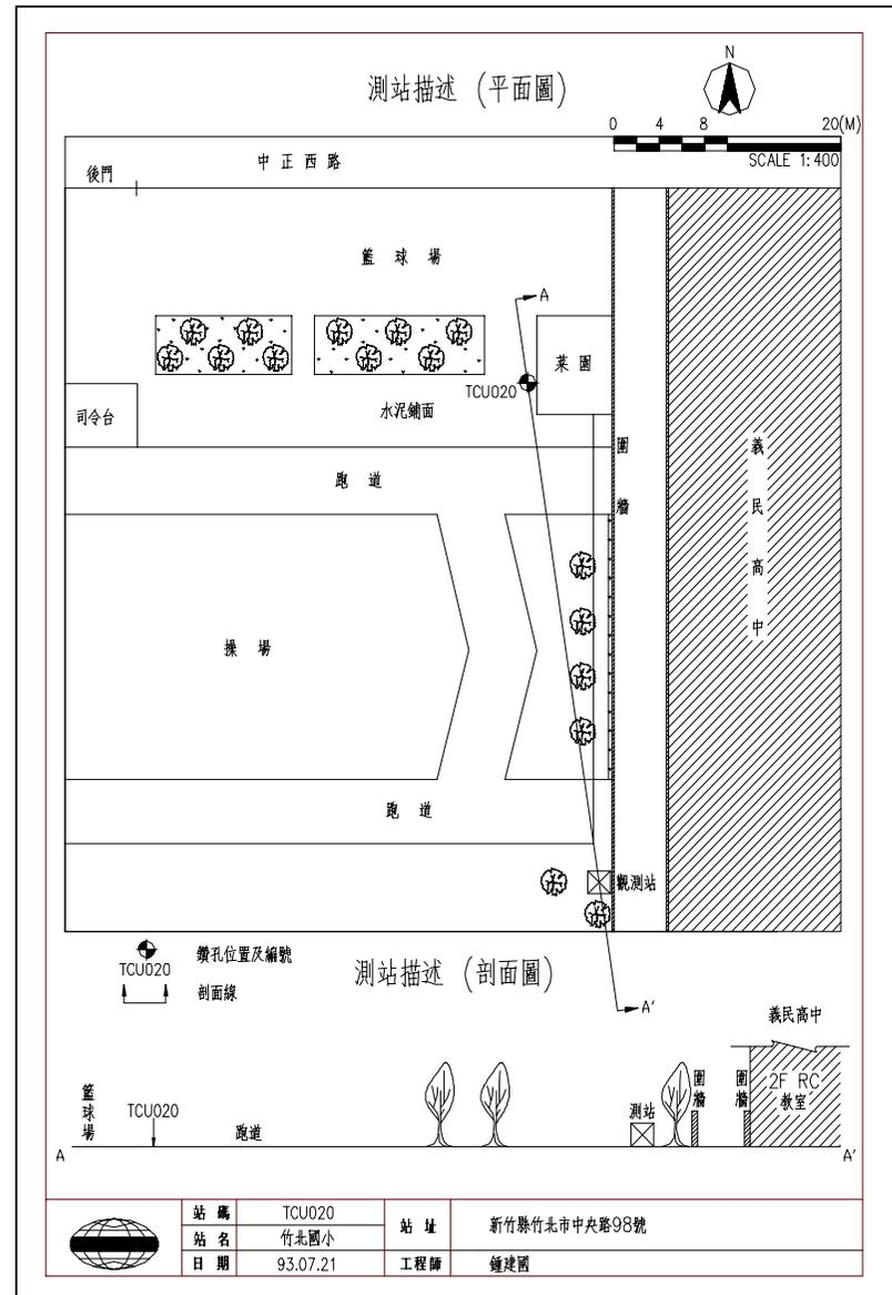
1. 本測站位於校園內運動場PU跑道東南角圍牆旁，地勢平坦，地表及鄰近圍牆未發現有明顯裂隙。
